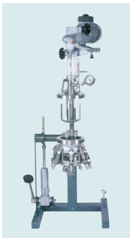
Kesseldeckel, Motor, Rührorgan, Zuleitungen und Aufbauten werden angehoben
