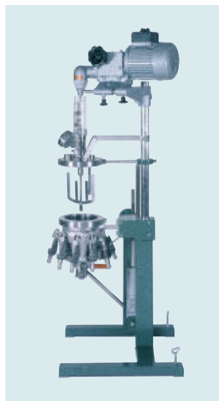
Unterteil des Reaktionskessels kann zum Reinigen abgebaut werden
