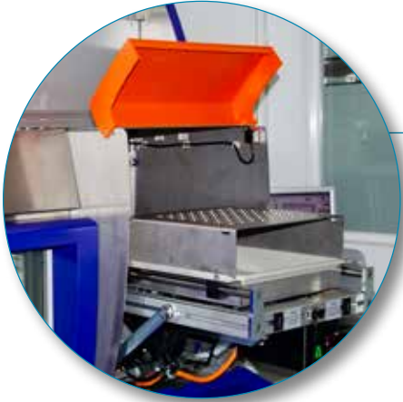
Es stehen zwei unterschiedliche Probenracks zur Verfügung: a) Ein Rack mit 56 Positionen für Probengefäße mit 20 ml bzw. 40ml (neu) Inhalt.
